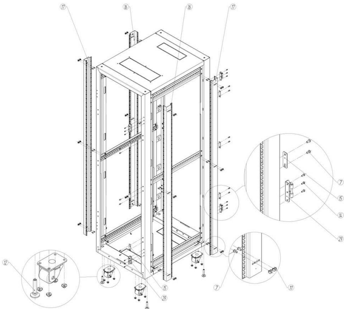
Установить в специальные места в нижней части рамок шарнирные регулируемые опоры (12).
