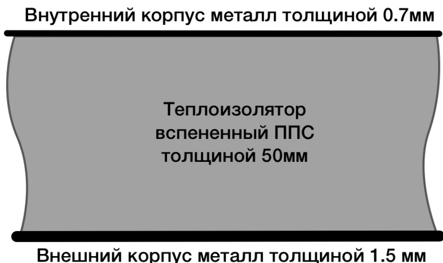
Рис. 1. Утепление шкафа по принципу «сэндвич панель»
