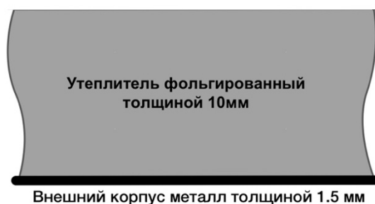
Рис. 1 Схема утепления шкафа
