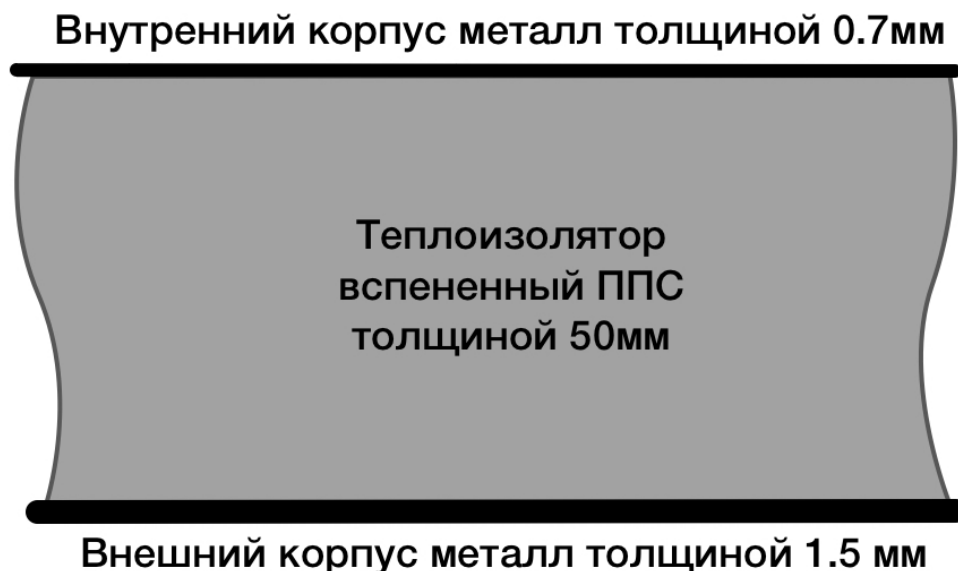
Рисунок 1. Утепление шкафа по принципу «сэндвич панель»
