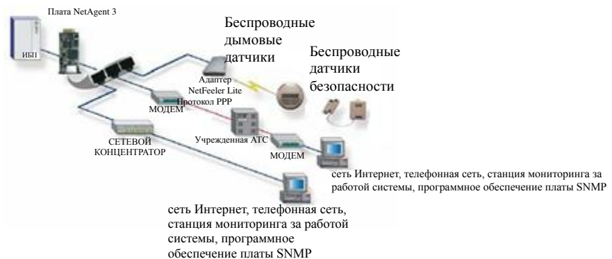
Стандартная топология сетевого управления ИБП.
