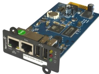
Внешний вид платы SNMP NetAgent с дополнительными портами
