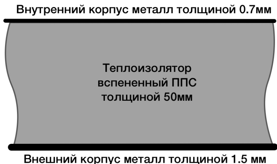
Рис. 1. Утепление шкафа по принципу «сэндвич панель»
