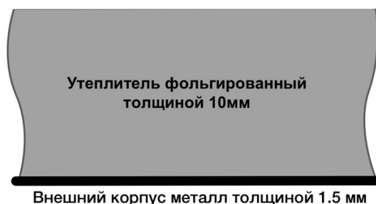
Рис. 1 Схема утепления шкафа.
